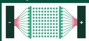
Durante le applicazioni più gravose, con le batterie con tecnologia tradizionale, l'energia passa in zone ristrette (stringhe, "tabs") con alta intensità. Questo provoca un surriscaldamento e l'interruzione del lavoro, lasciando una parte di energia inutilizzata.
