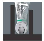
L'inclinazione ridotta della testa, di soli 15° raddoppia le possibilità di imbocco rendendo possibile manovrare in spazi estremamente ristretti. È anche più semplice trovare ogni volta il punto di imbocco su viti e dadi, grazie alla geometria a doppio esagono della forchetta.
